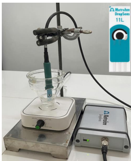
Hình 1. Máy đo điện hóa Metrohm Dropsens uStat400 kèm điện cực in SPE 11L.
