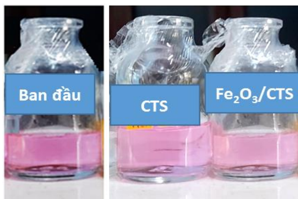
Hình 6. Dung dịch RhB trước và sau khi hấp phụ bởi vật liệu CTS và \text{Fe}_2\text{O}_3/\text{CTS} .
