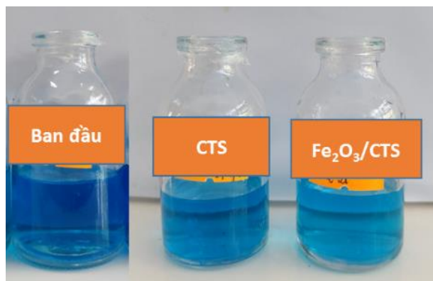
Hình 3. Dung dịch MB trước và sau khi hấp phụ bởi vật liệu CTS và \text{Fe}_2\text{O}_3/\text{CTS} .
